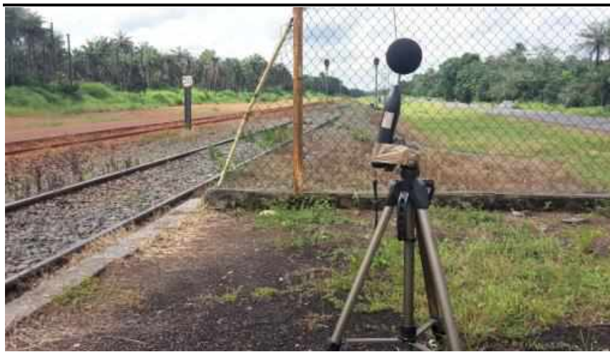
Figure 7.12 Mesures de bruit à la gare de Kolaboui
