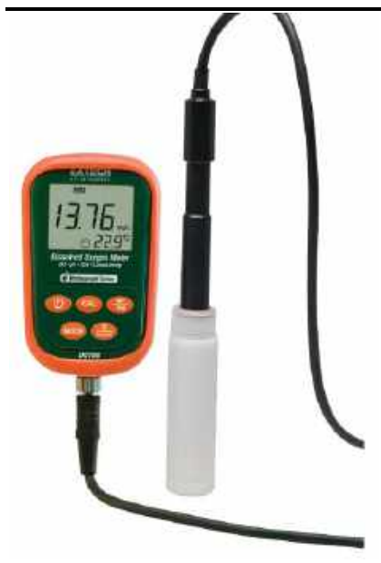
Figure 14.7 Système de mesure multi-paramètres sur site
